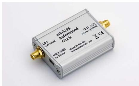
Ce module fournit une horloge à faible gigue, verrouillée en fréquence sur le signal GPS. La stabilité à long terme du signal de sortie est définie par la grande précision des références GPS. La stabilité du signal à court terme est définie par la source d'horloge TCXO interne.
