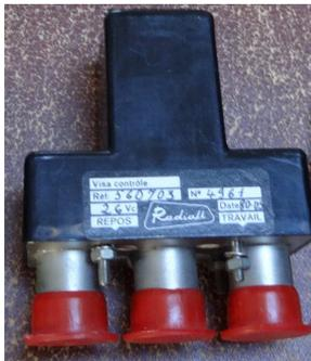
Les caractéristiques de la bobine ont été mesurées: inductance  $L=1\text{H}$ , résistance  $R=328\ \Omega$ , soit une constante de temps  $L/R=3\text{ms}$ . La tension nominale de ce relais est de 26V (soit un courant de 80mA). Il colle à partir de 15,4V (soit  $i=47\text{mA}$ ) et décolle à 6,5V (soit  $I=20\text{mA}$ ). On notera que c'est le courant dans la bobine qui crée le champ magnétique, on va donc tout d'abord s'intéresser à l'évolution de ce courant.
